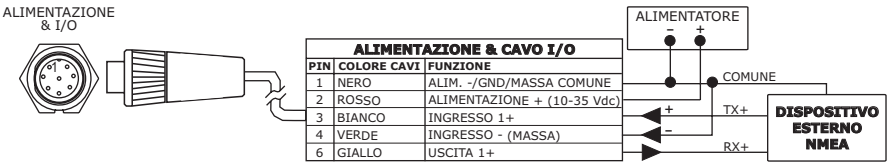
Connessione NMEA Esterno sulla Porta 1
