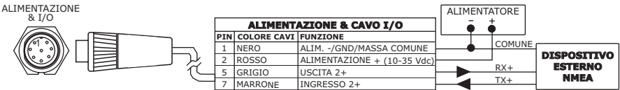
Connessione NMEA Esterno sulla Porta 2
