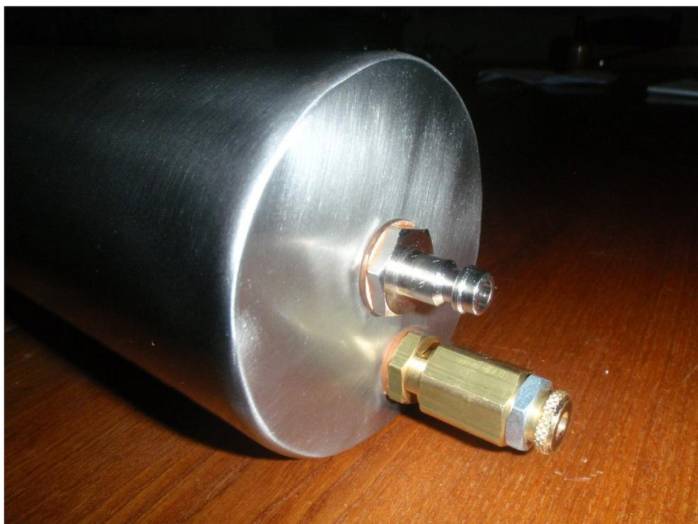
Da notare innanzitutto che l'attacco della pistola e quello sul cilindro sono di taglia diversa in modo da evitare errori di collegamento.
