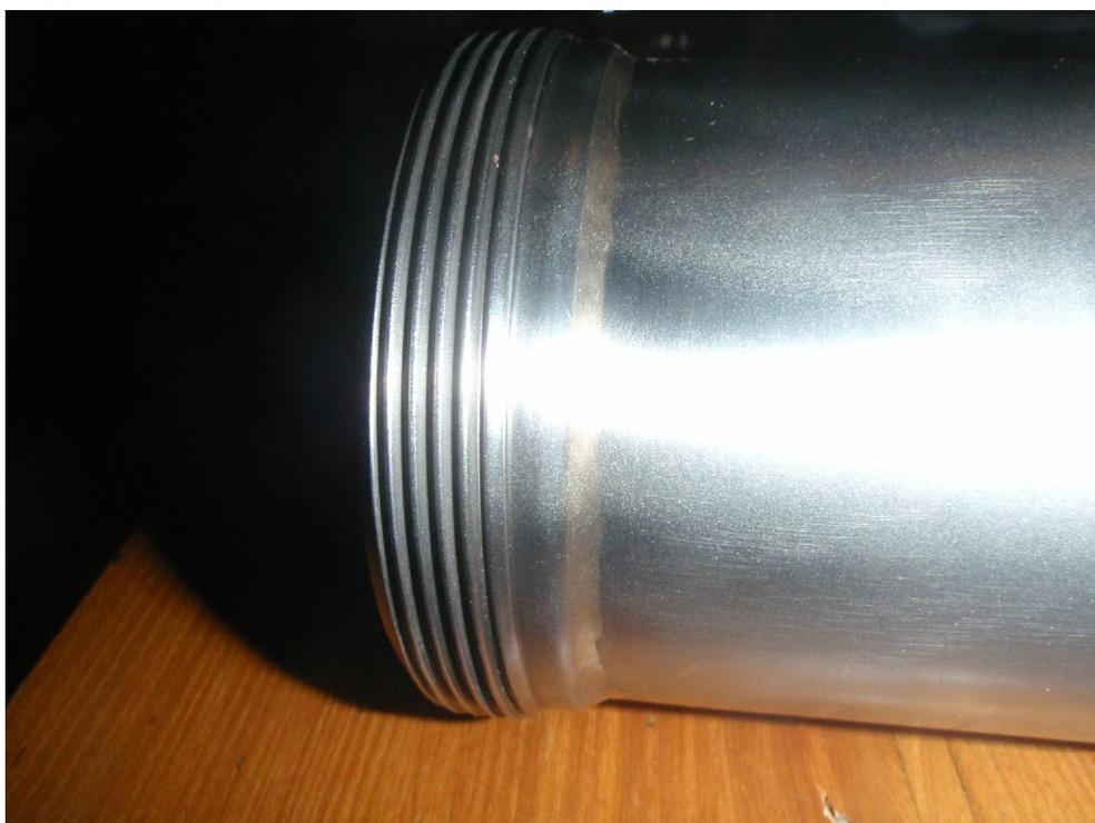
La ghiera filettata per il tappo è saldobrasata e tirata a lucido, ottima la scelta della saldobrasatura in quanto attacca perfettamente e, principalmente, non deforma il materiale evitando possibili inceppi del pistone durante la corsa.
