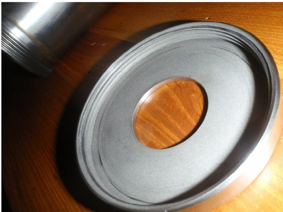
Il pistone è realizzato in nylon, ed ha due guarnizioni a labbro contrapposte oltre ad avere una forma particolare (disegno brevettato) per agevolare la stabilità nella corsa ed il ritorno in sede per il caricamento.
